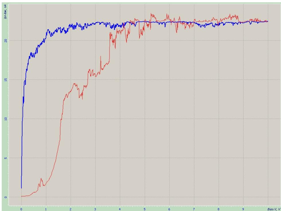
Рис. 4. ВАХ контакта АСМ-зонда к поверхности гелевой пленки  $\text{SiO}_2\text{-TiO}_2$ , измеренная в процессе формирования НЧ Au. Красная линия – развертка по напряжению в прямом направлении, синяя – в обратном направлении
